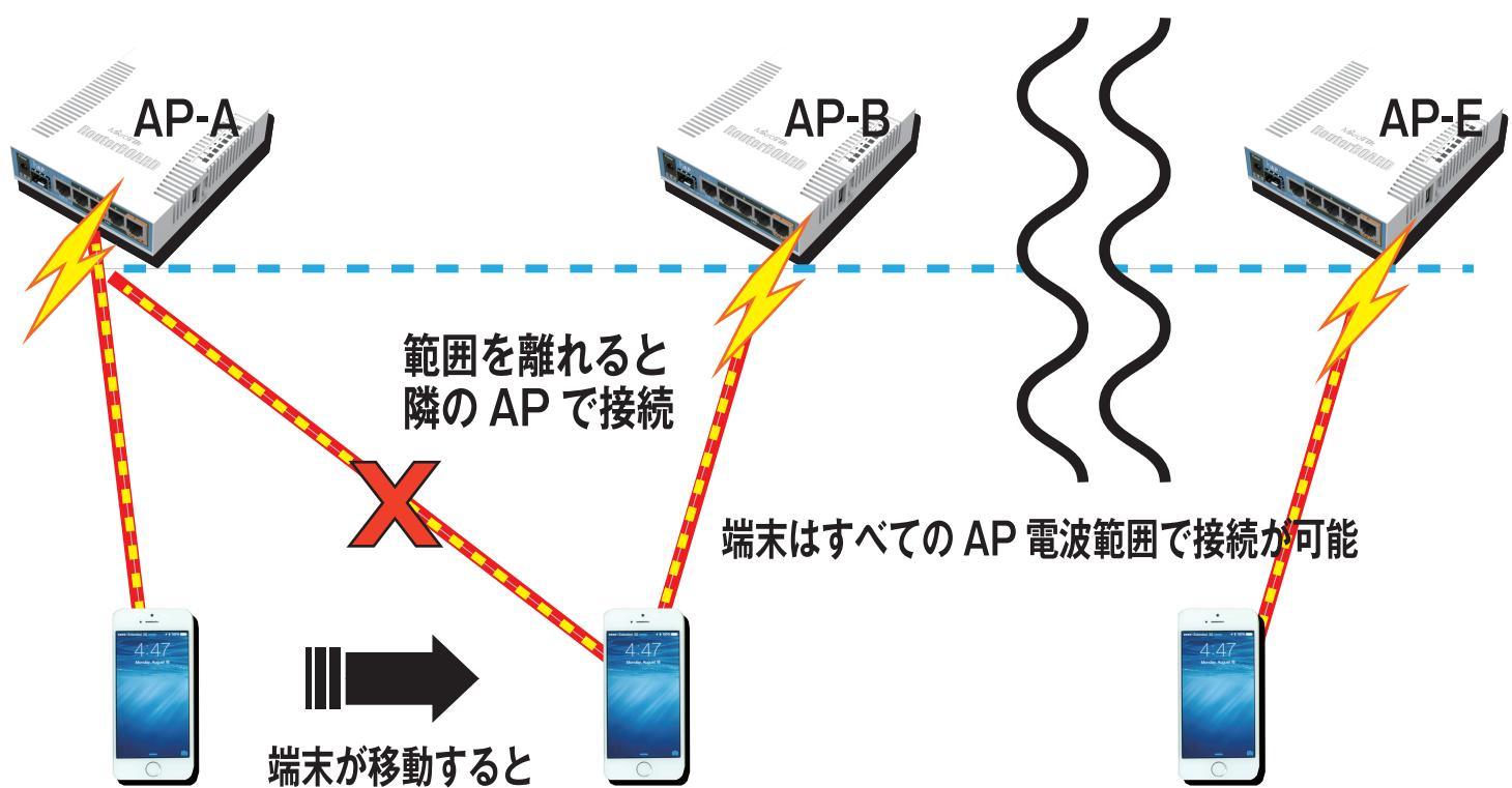
一般的な無線 LAN 機器は無線 AP 1台で PC 数台のインターネット接続が可能ですが、離れた場所の無線 LAN 機器を運用する場合は AP 毎に独立した設定で運用するしかありません。高価なワイヤレスコントローラーを利用して複数の無線 AP を制御出来る製品はありますが、無線 MESH ネットワークを使えば安価に複数の AP を 1つの無線機器のように使用する事が可能で、特定の AP から離れても次の AP で接続され、通信が可能になります。
